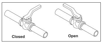
Figure 3.11. Valve Orientation
