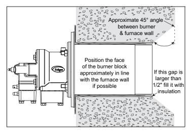
Figure 3.5. ThermJet Combustor Position
